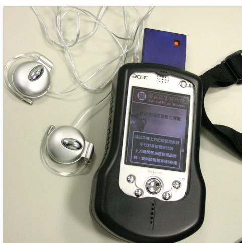
(a)感應式導覽設備外觀 (Pocket PC 加裝 RFID 讀取器與耳機)
