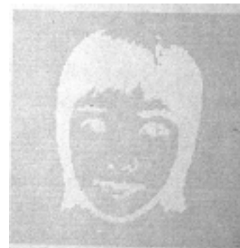
圖表 5. 將圖表 4.經複印機複印之後，浮水印潛像即浮現。
