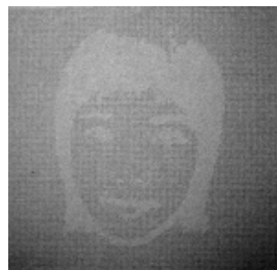
圖表 8. 利用掃描器在 600dpi 的解析度下掃描所得之影像，因為取樣不足可清楚偵測浮水印。
