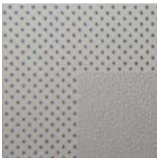
圖表 3. 經顯微鏡取像，其中左方及上方的網點是調幅(AM)網點；右下角細微的網點是調頻(FM)網點。
