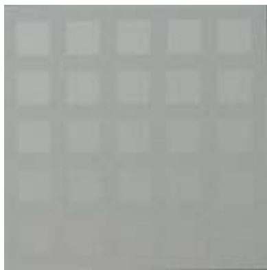
圖表 6. 藉由表格 2. 的灰階值校正導表影像列印輸出後，當顯現灰度一致時，則為適當匹配的參數以 3% 點陣調色網點為底時，匹配的 FM 網點灰階值為 221 或 220。
