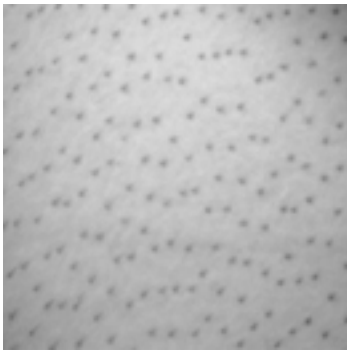
圖表 11. 印表機過網形成之誤差擴散網點之顯微影像，圖中顯示網點並非均勻散佈。
