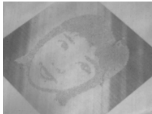
圖表 7. 利用 751pi 的柱狀透鏡光柵解碼，可清楚顯示隱藏之浮水印。
